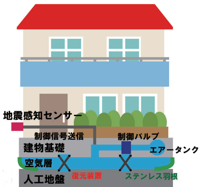
空気浮上免震の構造システム
